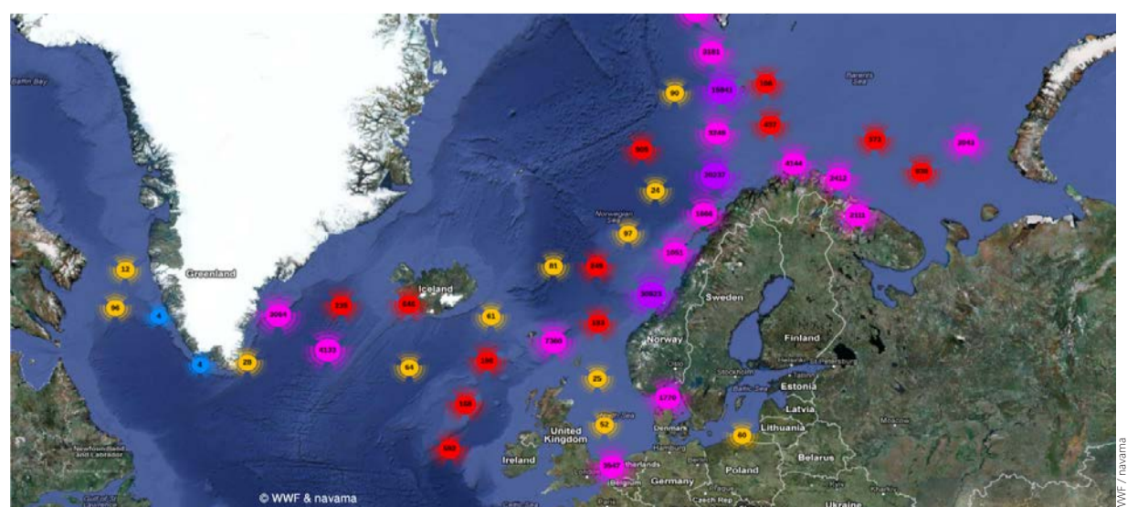
Durch Satellitentechnik ist der WWF der illegalen Fischerei auf der Spur. Über das Automatic Identification System, das Schiffe weltweit nutzen, können Routen und Aktivitäten auf hoher See, wie im Nordmeer, nachvollzogen werden.
